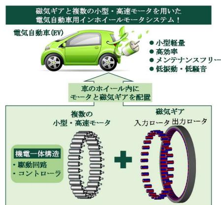
図 6 MMSG と高速モータを用いた EV 用インホイールモータシステム
